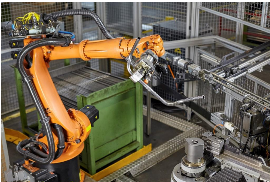
Bild: Fertigungsinsel Stahlenker
